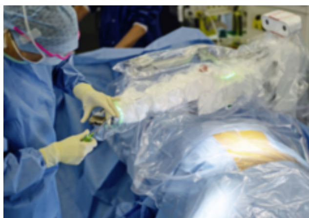
Afin de ne pas contaminer la zone stérile, le bras automatisé du Mazor X est recouvert de plastique.
